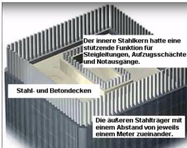
*Die äußere Struktur bestand aus parallel aneinander gereihten, vertikal ausgerichteten Stahlträgern. Sie hatten einen Abstand von einem Meter. Im Abstand von mehreren Metern wurden diese Stahlträger von einer horizontal ausgerichteten Stahlplatte verbunden. So entstand ein Außengerüst mit H – Form. Diese Außenskelette wurden zusammengeschweißt und dienten als massives Außengerüst.*
